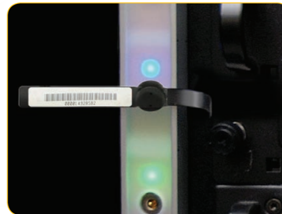
アセットマネジメントセンサ (AMS) AMTのID情報を読み取るセンサ。各U毎にカスタマイズ可能なRGBカラーLED
